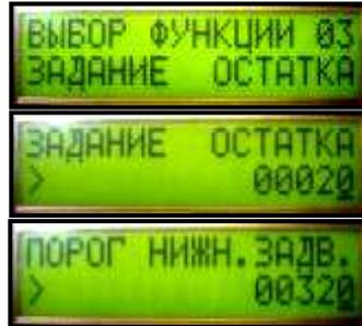
выгрузки продукта из весоизмерительного узла бункерных весов. Уставка "Остаток" задаётся аналогично уставке "Доза одного отвеса" (см. функцию 02). Уставка необходима для предотвращения останковки весов в случае загрязнения весового бункера, налипания продукта и т. п. Второе значение функции - «порог нижней задвижки», задает вес продукта (кг) в весовом бункере, который необходим для надежного открытия и закрытия нижней задвижки весов.
