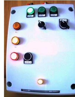
Настоящий паспорт распространяется на блок управления подачей продукта в расходные бункера (далее БУПМ-10Е), изготовленный ООО «Уралвес-Дон» и предназначенный для использования в составе дозирующих устройств, а так же в местах где необходимо обеспечить равномерную подачу материала.
